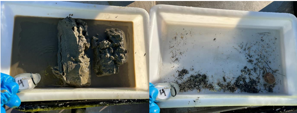
Figur 9: Bilder som viser sedimentet fra stasjon 4 før og etter siling. Sedimentet besto av leire og silt. Foto: Aqua Kompetanse AS.
